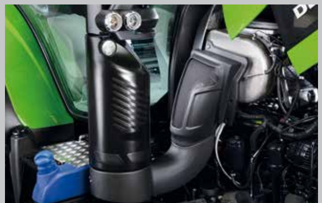
Système de post-traitement SCR et FAP (filtre à particules) passif pour une économie de carburant et des coûts d'exploitation.
