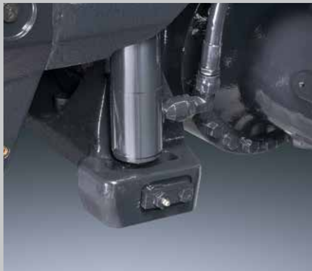
Unique. Le nouveau concept de pont avant heavy duty suspendu.
