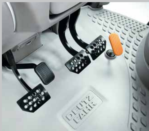
Le système de freinage assisté assure de grandes performances de freinage par faible pression sur la pédale.
