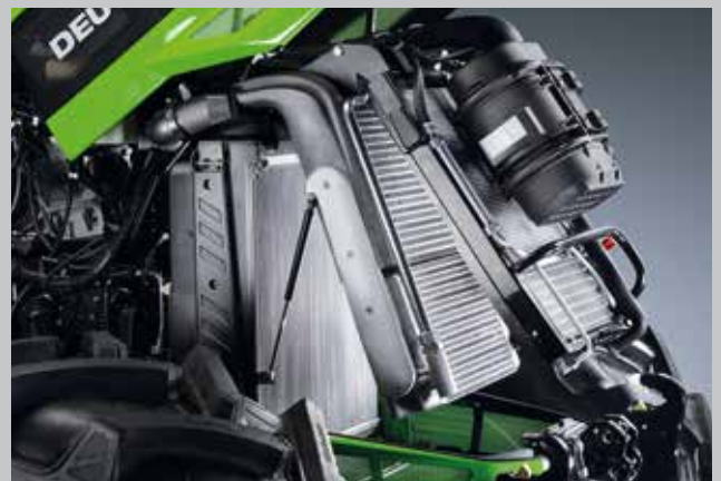
Nouvelle conception du circuit de refroidissement. Ouverture intégrale pour un entretien facile.
