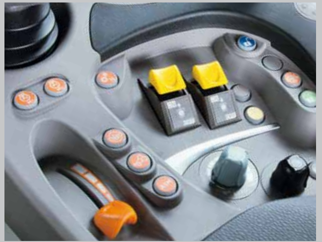
Commandes PDF (avant/arrière) et engagement judicieusement intégré à l'accouoir...
