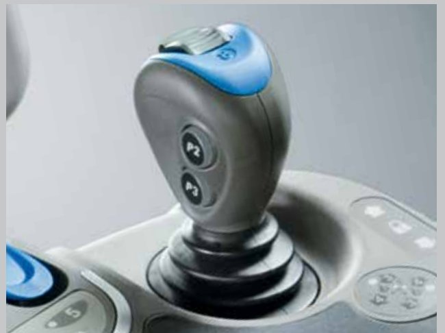
Les distributeurs hydrauliques sont commandés depuis une simple poignée avec smart wheel incorporée.
