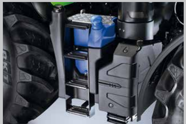
Réduction de consommation de carburant et d'AdBlue. Réservoir à gazole de 400 l et l'AdBlue de 50 l pour de longues sessions de travail.
