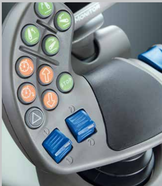
Jusqu'à 4 vitesses de croisière peuvent être mémorisées en vue d'optimiser les applications et l'efficacité du processus.
