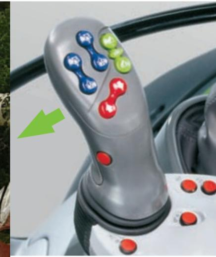
Il suffit de pousser légèrement le levier vers la gauche pour appeler la fonction suivante.
