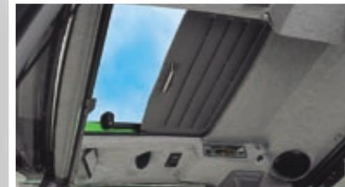
Le toit escamotable peut aussi être cloisonné de l'intérieur avec un store.
