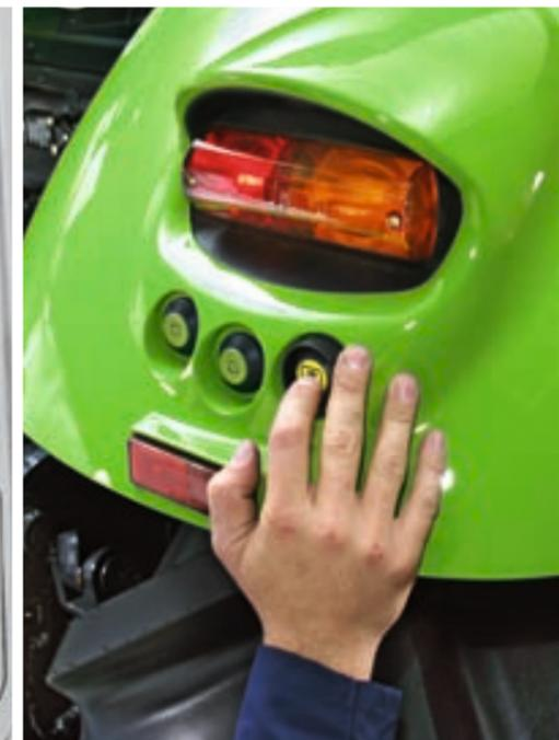
Les commandes de relevage et de prise de force se trouvent sur les ailes.
