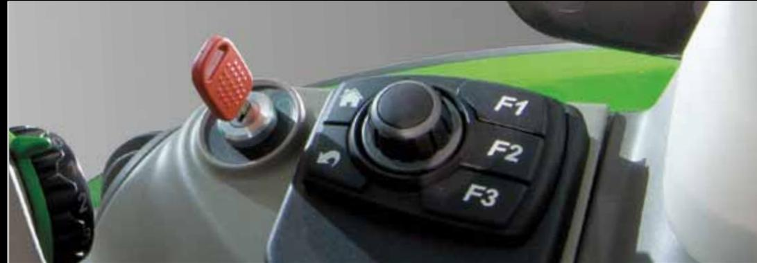
Le système intègre les fonctions suivantes : Menu principal pour le contrôle de toutes les fonctions du tracteur (relevage, PdF, distributeurs, moteur et transmission ASM et suspension cabine), Moniteur de performances (calcul de la consommation, de la productivité et des surfaces travaillées), menu ISOBUS pour l'utilisation d'outils compatibles, lecteur mp3 et dispositif de téléphone mains libres Bluetooth. Le confort et la technologie à portée de main.
