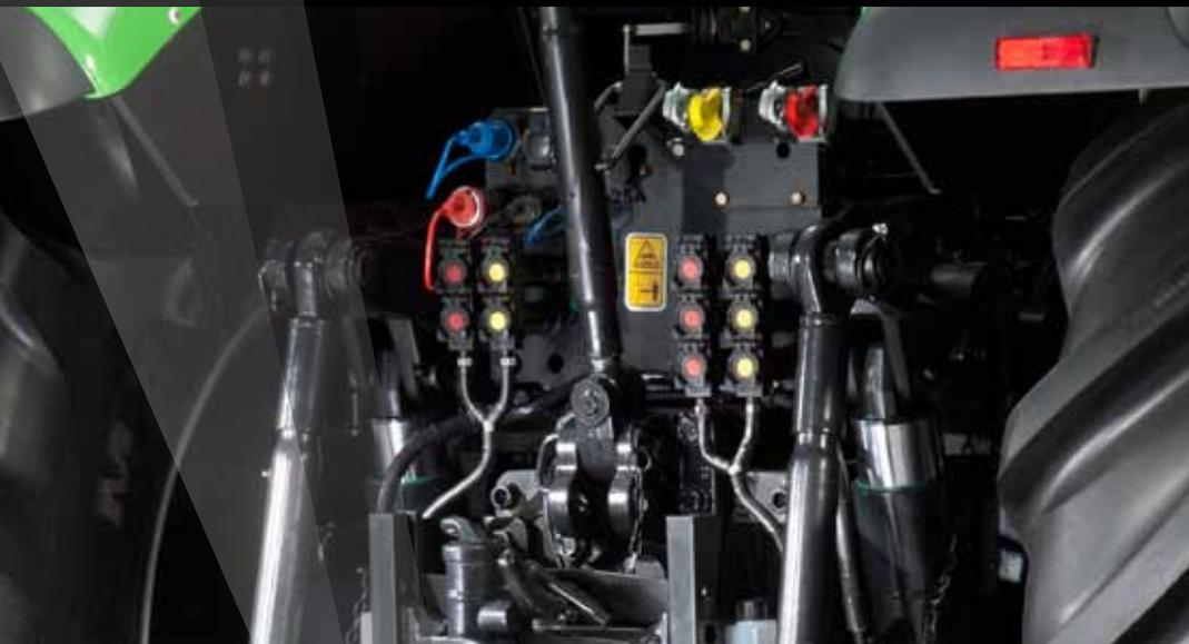
La capacité maximale de relevage arrière (aux rotules) est de 10 000 kg ; le relevage électronique EHR présent de série gère le contrôle d'effort, de position, et de patinage. Le relevage à régulation électronique EHR intègre également les fonctions terrage rapide, amortisseur d'oscillations, verrouillage de hauteur, limitation de la hauteur maxi et réglage de la vitesse de descente. La capacité maximale (aux rotules) du relevage avant (en option) est de 4 500 kg.
